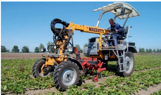
Werktuigendrager voor mechanische onkruidbestrijding Porte-outils pour contrôle mécanique des mauvaises herbes Tool-carrier for mechanical weed control
