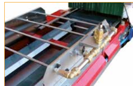
VP Tunnel di bagnatura
