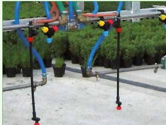
Ugelli autonomi su corridoio centrale e bordo esterno con valvole al centro Autonomous border nozzles on central walkway and exterior, with valves in the centre Boquillas independientes en pasillo central y borde externo con válvulas en el centro
