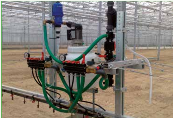
Applicazione dosatore e tanica a bordo Dosage unit with on-board tank Aplicación del dosificador y tanque a bordo
