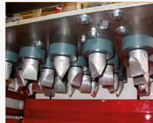
Piastra impronte a pioli rotanti (optional) Dibble plate with rotating tips (optional) Placa improntadora con punzones giratorios (equipamiento opcional)
