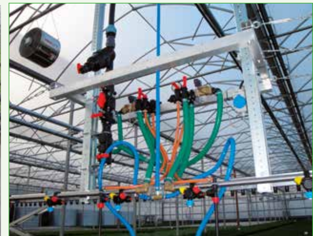
Elettrovalvole a bordo per apertura automatica lato destro/sinistro Solenoid valves on board for automatic left/right opening Electroválvulas a bordo para apertura automática lado derecho/izquierdo
