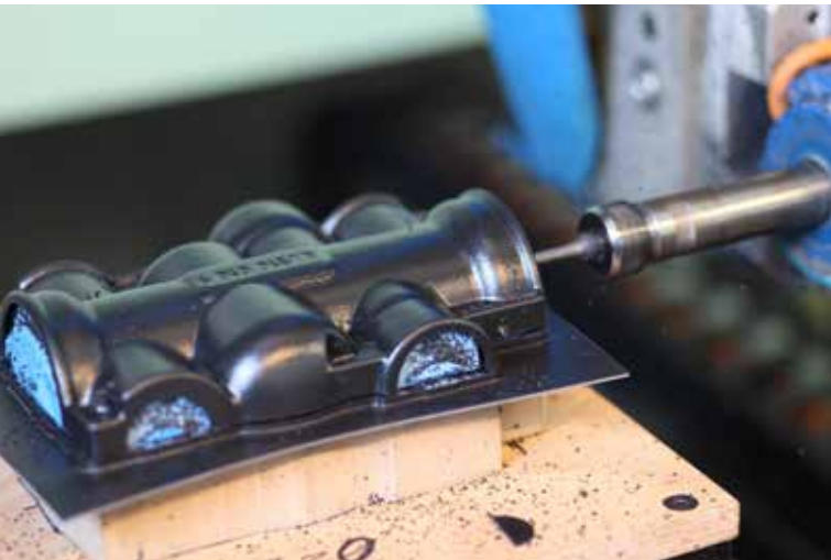
Herstellung der Diffusionsdichten Kälte­dämmungen | Production of diffusion-tight cold insulation
