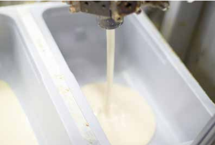
Herstellung der PU-Dämmungen | Production of PU-Insulation
