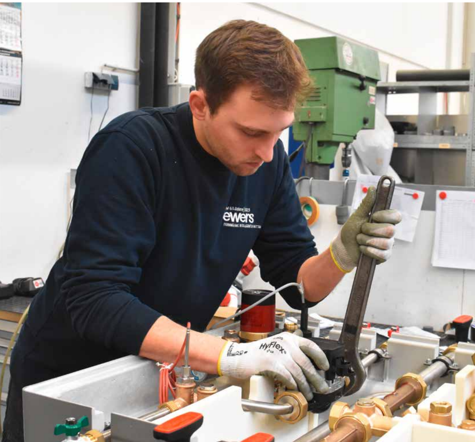
Montage unserer Wärmeübergabestationen auf Montagerahmen | Mounting of our heat transfer stations on mounting frames
