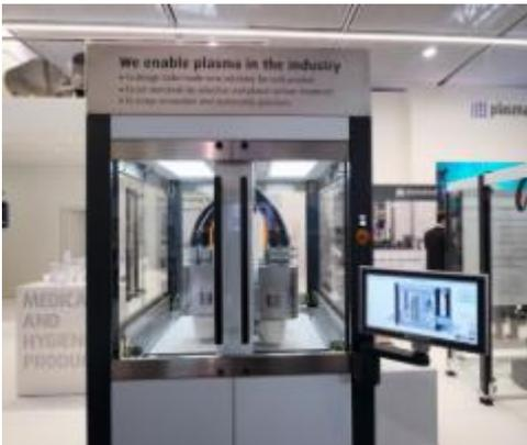
Plasmatreat wird ein spezielles Plasmasystem mit acht rotierenden Düsen zur Behandlung von Materialien, z. B. Bleche für die Dosenproduktion, vor dem Bedrucken oder Lackieren zeigen. (Copyright: Plasmatreat GmbH)
