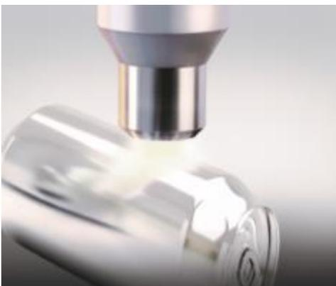
Die Oberflächenbehandlung mit Openair-Plasma ermöglicht eine vollflächige und homogene Benetzbarkeit der Oberfläche mit UV-Farben oder -Lacken, die nun optimal auf der Metalloberfläche ohne den Einsatz chemischer Haftvermittler (Primer) auf dem Substrat haften. (Copyright: Plasmatreat GmbH)
