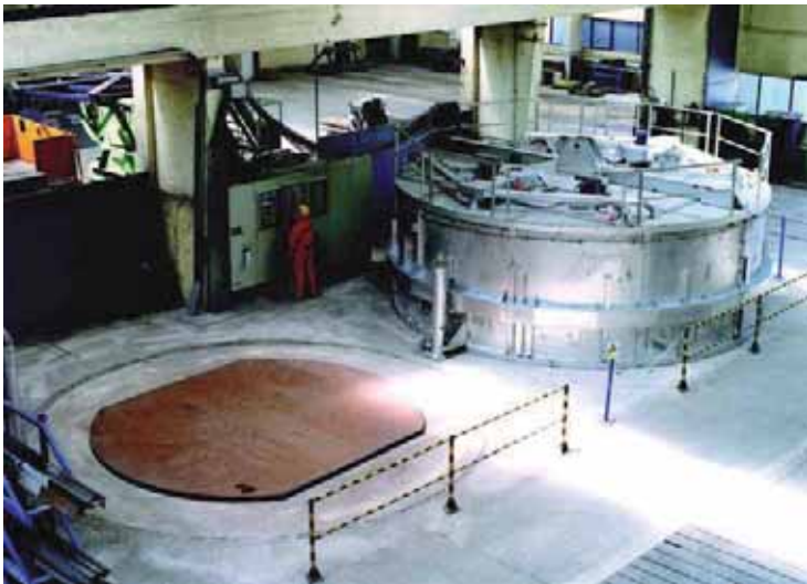
Elektrisch beheizter Rundofen Innendurchmesser: 6000 mm Lichte Höhe: 2000 mm Installierte Leistung: 540 kW
