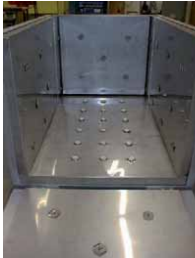
Vorwärm- und Glühboxen für das Vorwärmen und Spannungsarmglühen von Werkzeug- und Gesenkschmiedeteilen
