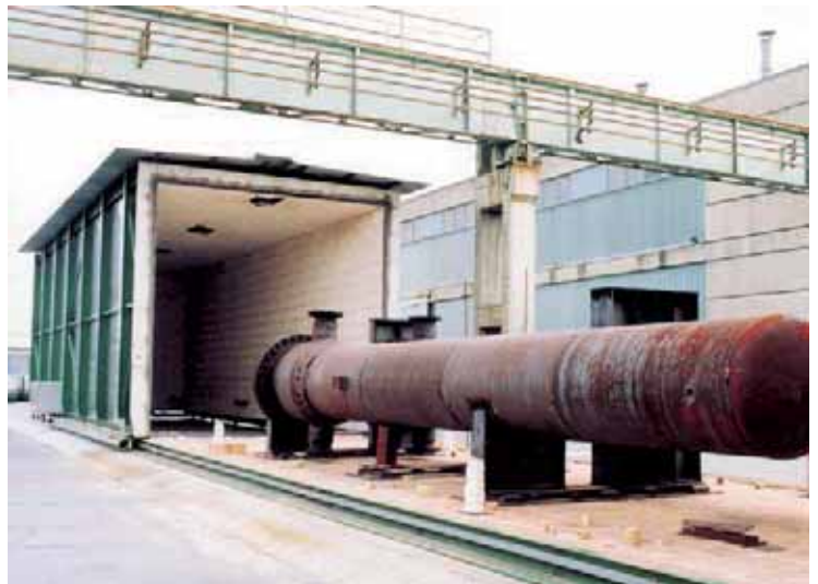
Gasbeheizter Glühofen zum Spannungsarmglühen von Großbehältern Lichte Breite: 6000 mm Lichte Höhe: 6000 mm Lichte Länge: 16000 mm
