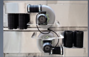
Zwei kraftvolle Lüfter und vier Filter auf der Rückseite
