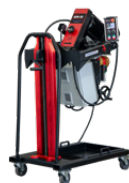
ABM-50 • Fasenbreite bis 50 mm (45°)/bis 66 mm (15°) • Ober und Unterfase • automatischer Vorschub • Faswinkel Oben 15°-60°/ Unten 15°-60°
