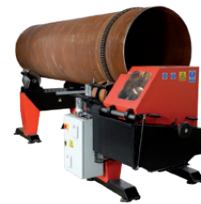
PRO-40 PBS • Rohr AD 200-1000 mm • Edelstahlbearbeitung • J-Fasen
