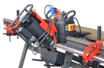
ABM-28 • Fasenbreite bis 35 mm • Plandrehen, Ober und Unterfase • automatischer Vorschub • J-Fasen (Option) • Entplattierung (Option)
