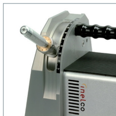
Schleifen der Elektrode im gewünschten Winkel.
