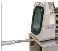
Präzise Längenjustierung der Elektrode.
