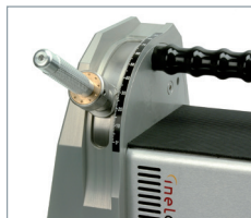
Schleifwinkel von 7,5-90° ermöglichen Spitzwinkel von 15-180°.
