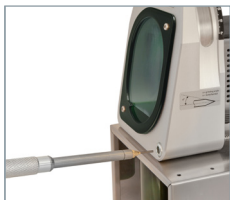
Präzise Längenjustierung der Elektrode.
