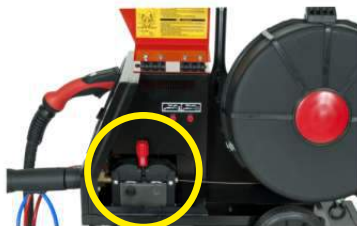
50W 4 rolls motor / Moteur 50W 4 galets Motor 50W 4 rodillos / Motor 50W 4 roletes
