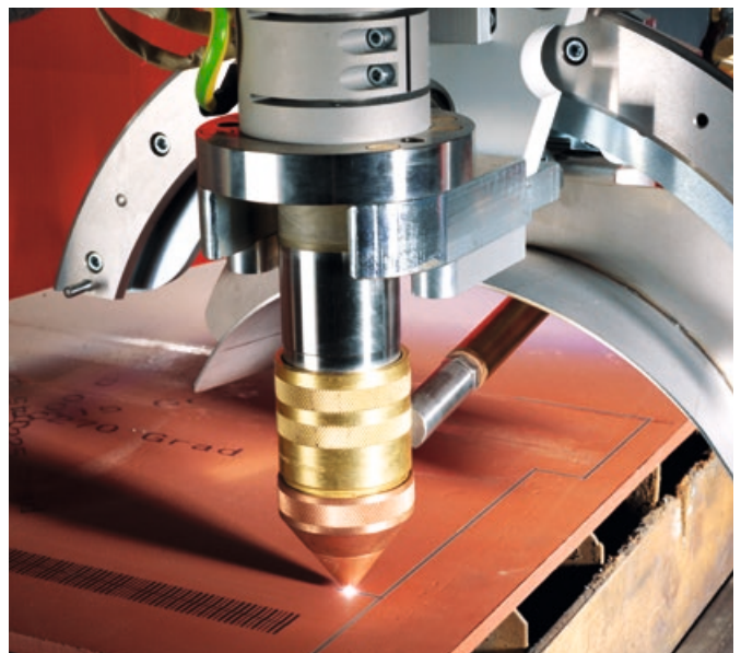
Plasmaschneiden für die Feinstbearbeitung von Blechen
