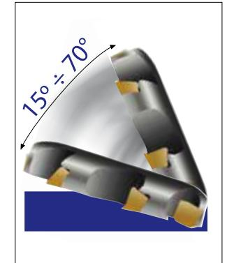
par usinage pour grandes épaisseurs. Jusqu'à 60 mm chanfrein.
