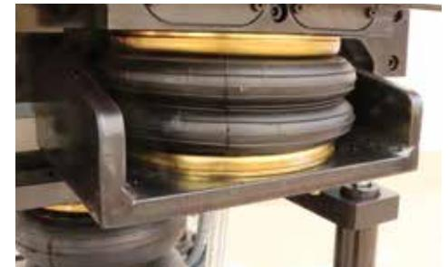
Système pneumatique pour fixer le matériau.
