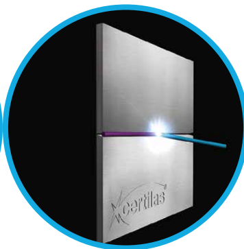
Achse der Schweißnaht Horizontal Horizontal-Position ASME : 2G ISO: PC
